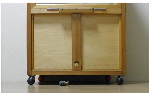
7. 写真中央下部の穴は、ふいごで送風するためのもので、この穴は二本の木を斜めに半分ずつ彫り込んでから接着して作っている。そのため送風すると松脂の粉末に直接当たる。床にあるのが使用しないときの栓になる。
