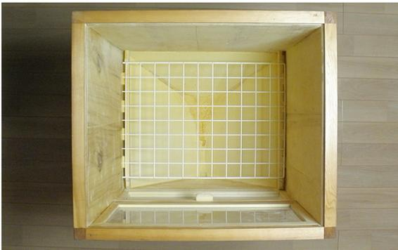
2. 写真は上から見たところ。内部側面は、松脂の粉末が溜まらないように平面にしている。金ネット下の底の中央に見えるのが、松脂の粉末である。この蓋を外した状態で、綿布で包んだ松脂の粉末を、手のひらで軽く叩いて散布することもできる
