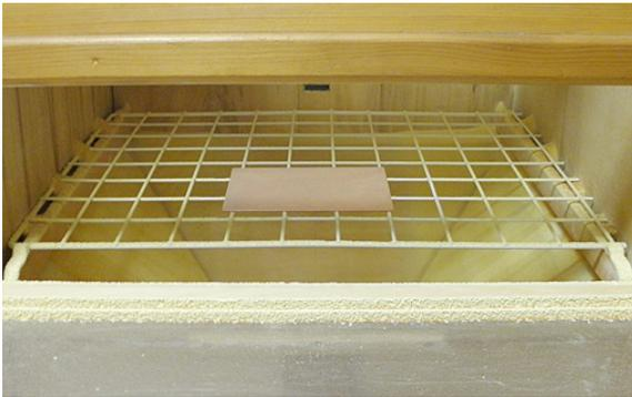
10. 松脂の粉末を散布して取り出すところ。銅版の表面が白く曇っている。松脂を散布し終えた後は、慎重に扱わないと、せっかく散布した松脂が動いてしまう。この後、加熱して定着さす。
