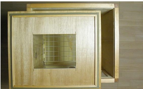
4. 写真は蓋の裏で、周囲には隙間用のスポンジ・テープを貼り、中央部には採光ようにガラス板を嵌め込んでいる。
