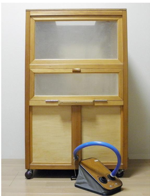
8. ふいごで送風して松脂の粉末を巻き上げた状態。アクアチント・ボックス内は、もやがかかったように見えている。この後、銅版を入れて松脂の粉末を受ける。早く入れた場合は粗い粒子が、少し時間をおいて入れた場合には細かい粒子の粉末を散布することができる。尚、写真のふいごは踏み加減により、巻き上げる松脂の量を調節することができる。このホースの先には散水用のノズルを付けているので、送風をアクアチント・ボックスの中の一点に集め、松脂の粉末を巻き上げることができる。
