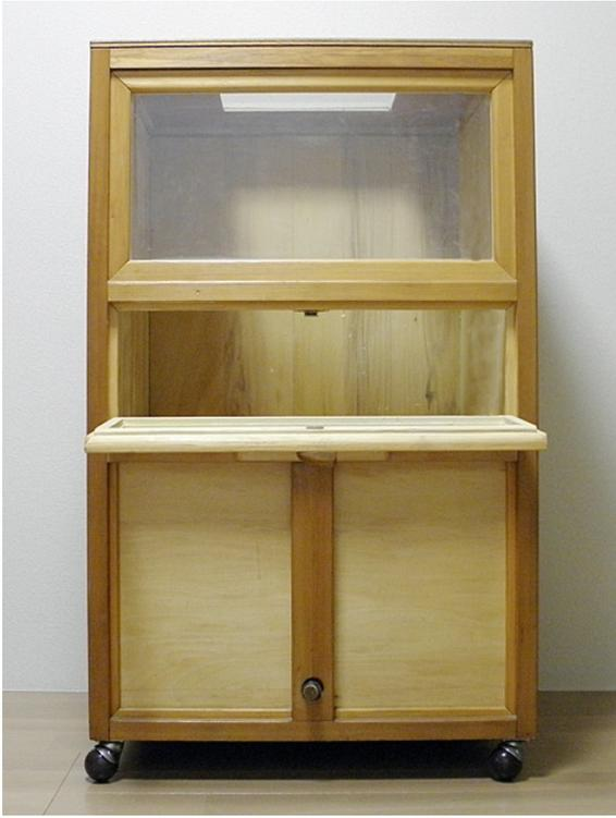
1. 写真は開閉部を開けた状態。開口上部と扉の上部には、磁石と金具を取り付けている。金ネットは、市販のものを必要な大きさに切り取り、左右に棧を取り付けて乗せている。この書で説明に使用しているプレス機のベッドプレートの寸法が535ミリ×1100ミリなので、印刷用紙の余白を考慮して開口部及び箱の大きさを決めた。そのアクアチント・ボックス及び開口部の寸法は次の通りになる。
