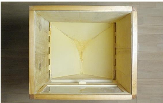
3. 銅版を乗せる金ネットを取り外した状態。この底は松脂の粉末を溜めるところで、両側と奥を斜面にして谷になるようにベニヤ板を貼り付けている。こうすることで、舞い上がった松脂が一カ所に集まる。
