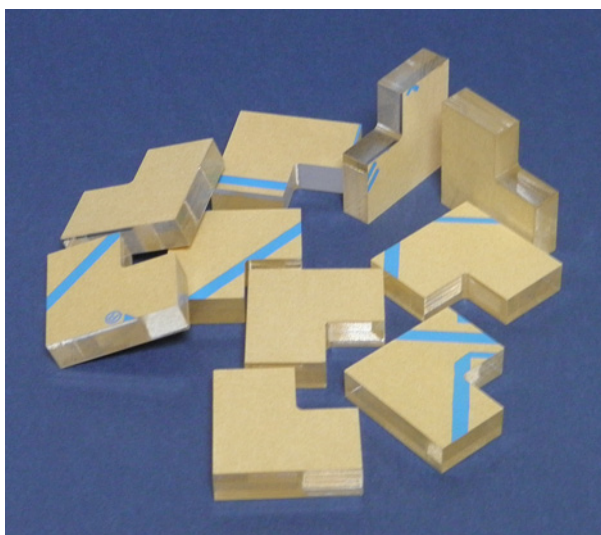
1. 厚さ10ミリのアクリル板を40×40ミリで切り取り、その一角を17×17ミリで切り取る。
