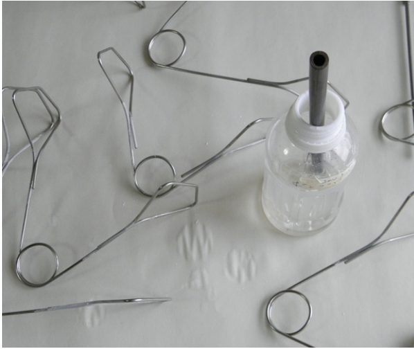
13. ロウ付けをする前に、ロウ付け用の酸化防止脱脂液を塗る。
