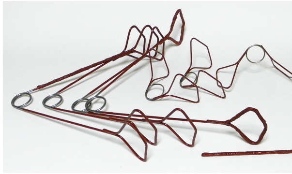
2.右下の棒は単に樹脂を塗っただけのもので、堅いものに叩きつけると簡単にヒビが入る。
