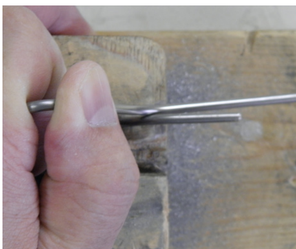
12. 片方の添える軸も削り、密着するように整える。
