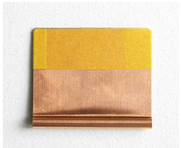
14. 角を丸める為に先に金切りばさみで落としておく。写真は落とした状態になる。
