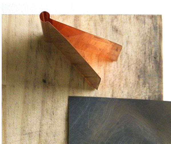
18. 切り口が鋭利になっているので、その断面に# 2000番の耐水研磨ペーパーを当てる。
