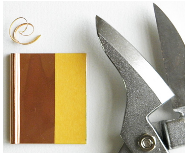
12. 印した線に沿って金切りばさみで切り取る。写真のものは反りを作らずに切り取ることができる。
