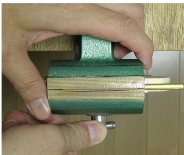
8. 写真は締め付けた状態で、この後取り出して圧が均等にかかっているか確かめる。そうでなければ、向きを変えて再度締め付ける。
